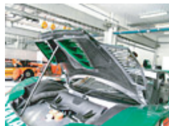
ボンネットに追加された エアダクト
